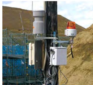
水位、雨量、pH、伸縮等、アナログ出力を持つ各種計測器を接続するデータロガーとしての利用が可能です。また通信状況の悪い山間部などで安定した通信を実現するため、衛星通信にも対応しています。
