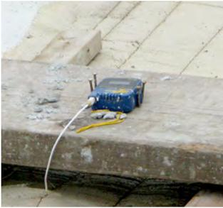
コンクリート打設の際に重要となる、コンクリート温度、養生内気温、外気温を同時に24時間計測し、遠隔地からの適切な温度管理を可能にします。
