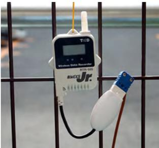
通常の温度センサーは生コンクリートに直接埋め込むため使い捨てとなりますが、熱電対センサーは埋設した部分のみを切断してリード線の長さの分だけ繰り返し使用できるため、コストを抑えた温度測定を行うことが可能です(オプション対応)。
